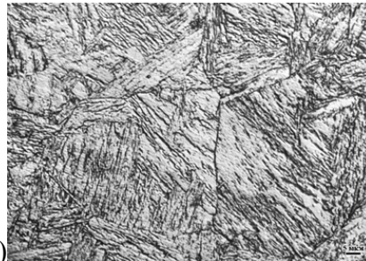
Рисунок 14 – Микроструктура первого участка ЗТВ после отпуска при температуре 600°C и охлаждения с печью (а) и на воздухе (б)
